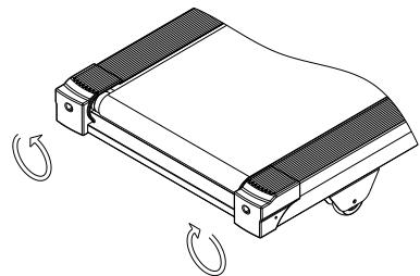
Если полотно смещено влево, поверните левый регулировочный болт на  $\frac{1}{2}$  оборота по часовой стрелке, а правый – на  $\frac{1}{2}$  оборота против часовой стрелки.
