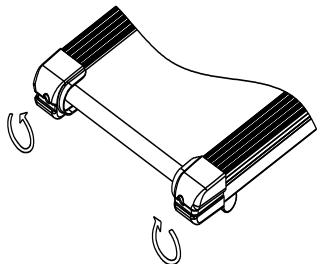
Если беговое полотно смещено влево, поверните левый регулировочный винт на пол оборота по часовой стрелке, а правый регулировочный винт – на пол оборота против часовой стрелки.
